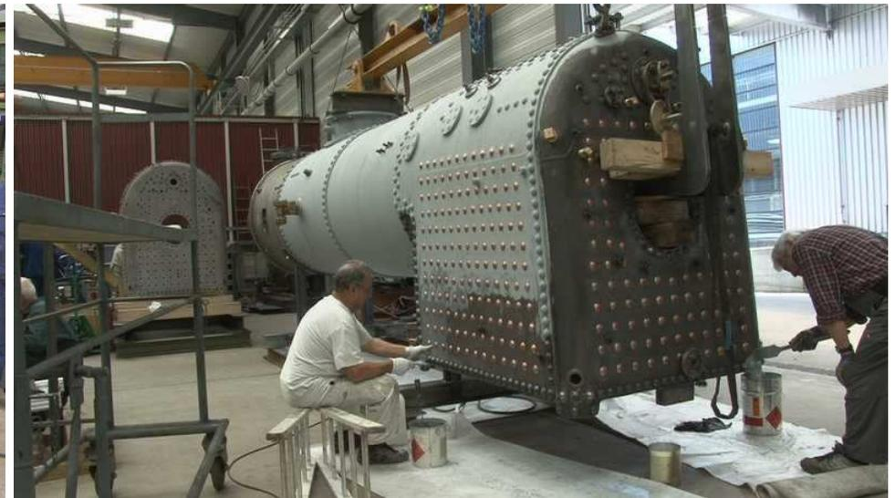
Ricostruzione ex novo caldaia vapore Furka Bahn Svizzera
